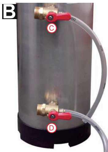
POLOHA UZAVŘENO A ODPUŠTĚNÍ TLAKU OBĚ PÁČKY OTOČENY VPRAVO
